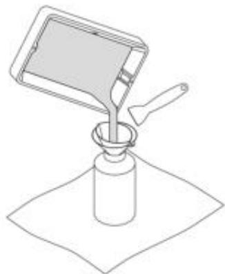
取出料槽，将料槽内剩余的树脂通过过滤器和漏斗倒入树脂瓶内，如有必要可使用塑料胶铲辅助；完成后，清洗树脂过滤器，也可以用同样的液体清洗树脂料槽。用纸巾清洁树脂料槽液，也可用树脂洗涤剂或 90% 酒精清洗树脂料槽。清洁打印平台，打印屏幕，树脂料槽干净后；将其重新安装到打印机中，并扣紧料槽固定。将打印平台装回打印平台悬臂，拧紧固定螺丝，将 UV 遮光罩盖在打印机上。
