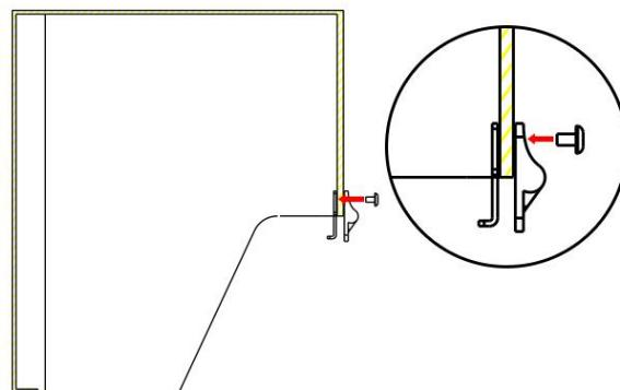
3. 铰链下端翻起一定的角度，随后，如右图所示，将组合好的遮光罩合页弯钩插入后壳孔内，并盖上遮光罩。
