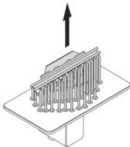
戴手套使用美工刀沿着模型四周小心切下模型，然后用高浓度工业酒精（95%以上）对模型进行清洗，清洗后使用吹风机吹干表面酒精，模型表面干爽不反油光后清洗完成，否则按以上步骤继续清洗吹干。注意：模型未清理完前请勿暴露于紫光中。
