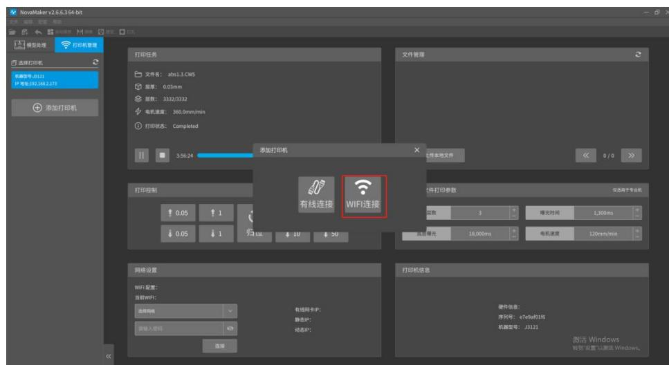
输入打印机上显示的 IP 地址，点击下一步，等待连接成功，左侧选择打印机下方会出现已经添加的打印机。
