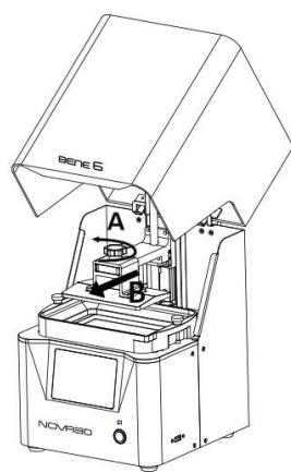
注意不要将液体树脂溅到打印机上及其周围。将UV遮光罩盖在打印机上，避免其他紫光将料槽中的树脂固化。
