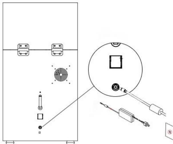
长按前面板电源即可开机；通过 Wi-Fi 或以太网将其连接到网络，根据菜单中的选项设置和配置连接。
