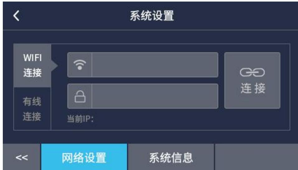
打开 NovaMaker 软件，点击左侧菜单栏打印机管理按钮进入打印机管理界面，然后点击添加打印机按钮，会显示“添加打印机指引”的弹框，选择 WIFI 连接。
