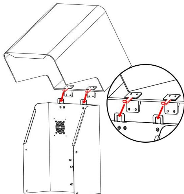
4. 如右图所示，将铰链翻下，贴在打印机后壳上，取出 M4\*6 螺丝 4 个，将铰链锁附于后壳上。
